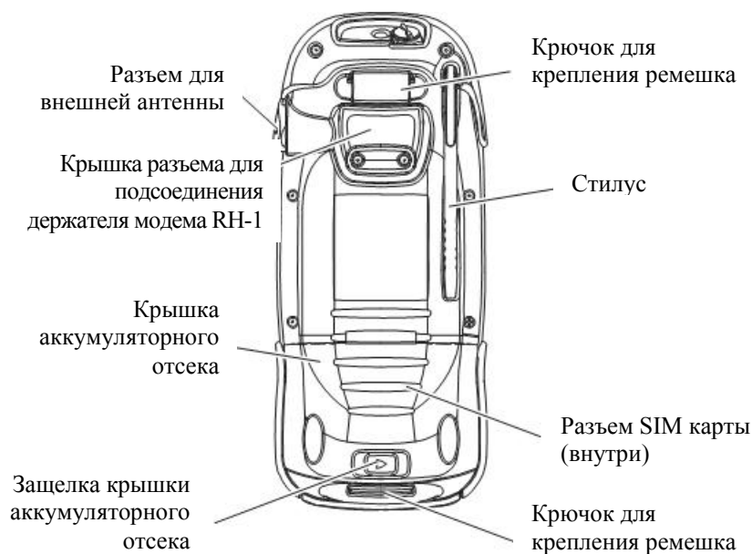
Рис. 1-4. Задняя панель GRS-1
