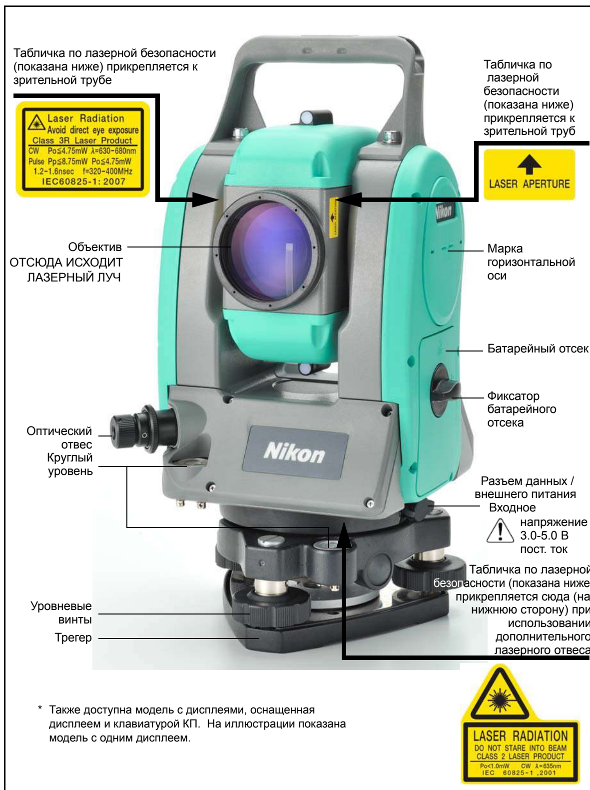
Рисунок 1.2 Электронный безотражательный тахеометр серии Nivo – Сторона-2
