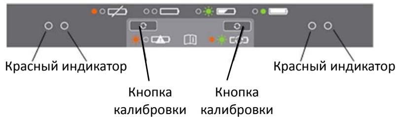
Рисунок 3.6. Панель управления зарядного устройства на две батареи
