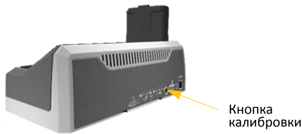
Рисунок 3.4. Кнопка калибровки на зарядном устройстве
