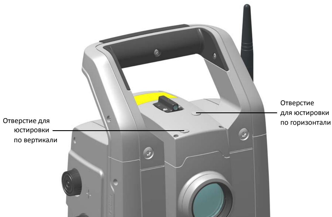
Рисунок 4.5. Отверстия юстировочных винтов лазерного указателя
