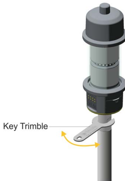
Рисунок 6.17. Установка и снятие цели Trimble Active Track 360
