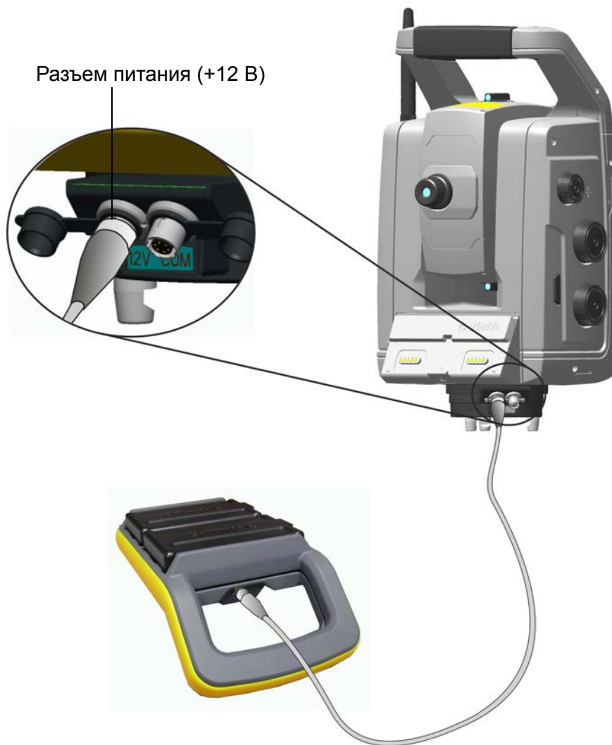
Рисунок 6.2. Подключение адаптера для нескольких батарей
