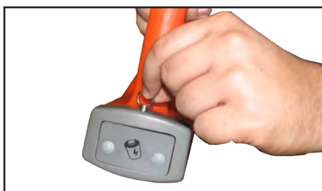
а) Выдвинуть фиксатор и освободить батарейный отсек
