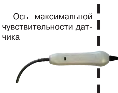
Выбор кабеля по максимальному сигналу
