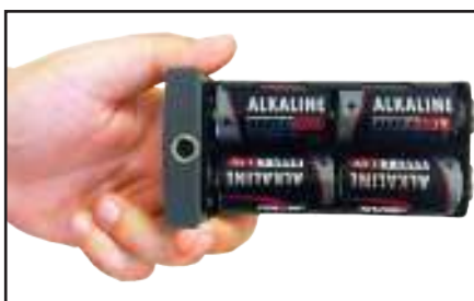
б) Вставить батареи в отсек, соблюдая полярность
