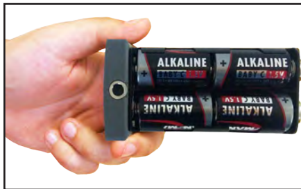
б) Вставить батареи в отсек, соблюдая полярность
