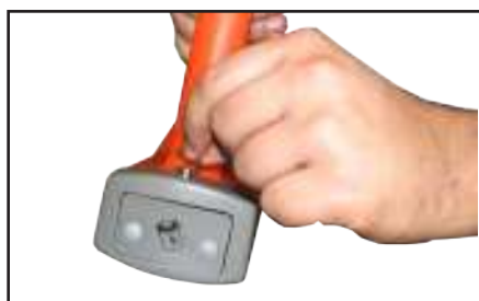
а) Выдвинуть фиксатор, освободить батарейный отсек
