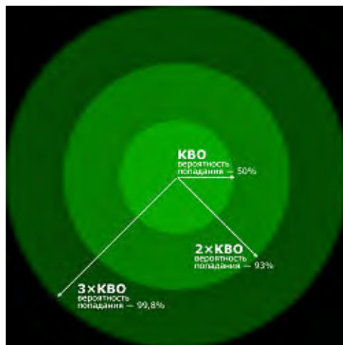
Рис.4. Геометрическое представление КВО - Кругового Вероятного Отклонения.
