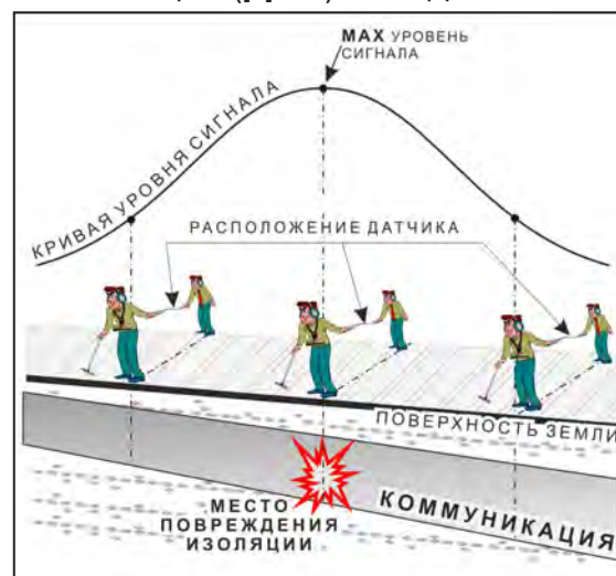
применение датчика-определителя дефектов коммуникации (ДОДК) методом max
