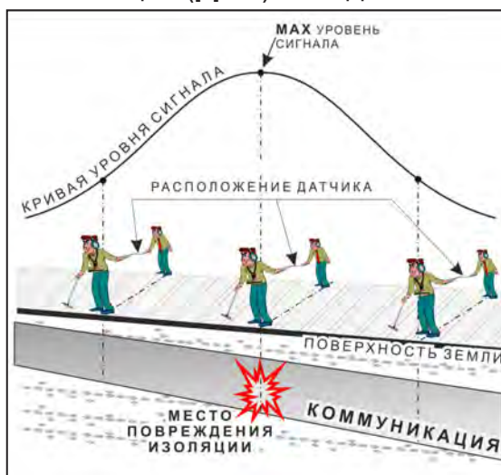
применение датчика-определителя дефектов коммуникации (ДОДК) методом max
