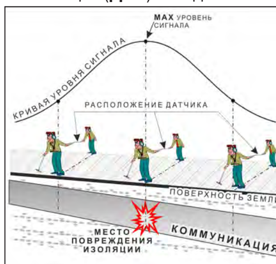
применение датчика-определителя дефектов коммуникации (ДОДК) методом max
