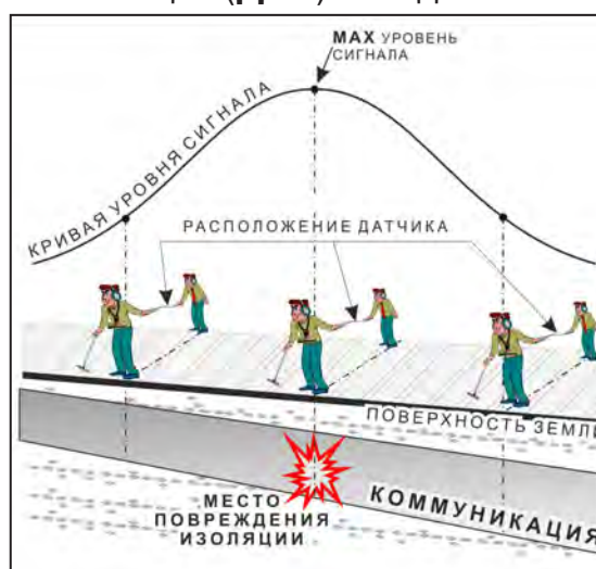
применение датчика-определителя дефектов коммуникации (ДОДК) методом max
