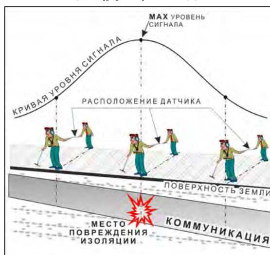
применение датчика-определителя дефектов коммуникации (ДОДК) методом max
