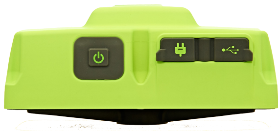
Рисунок 4. Кнопка вкл/выкл, разъемы питания и USB
