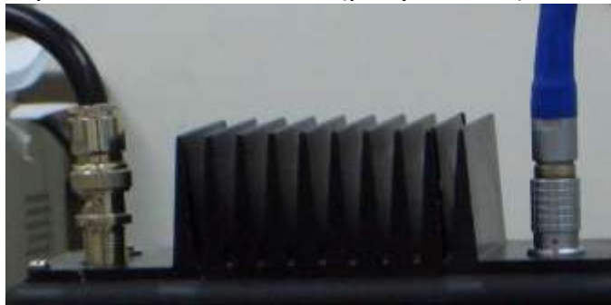
Рисунок 2.6 – Внешний вид разъемов для подключения антенны и GPS – приемника в GDL25
