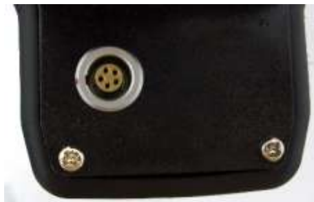
Рисунок 2.7 – Внешний вид разъема для подключения GPS – приемника в GDL25
