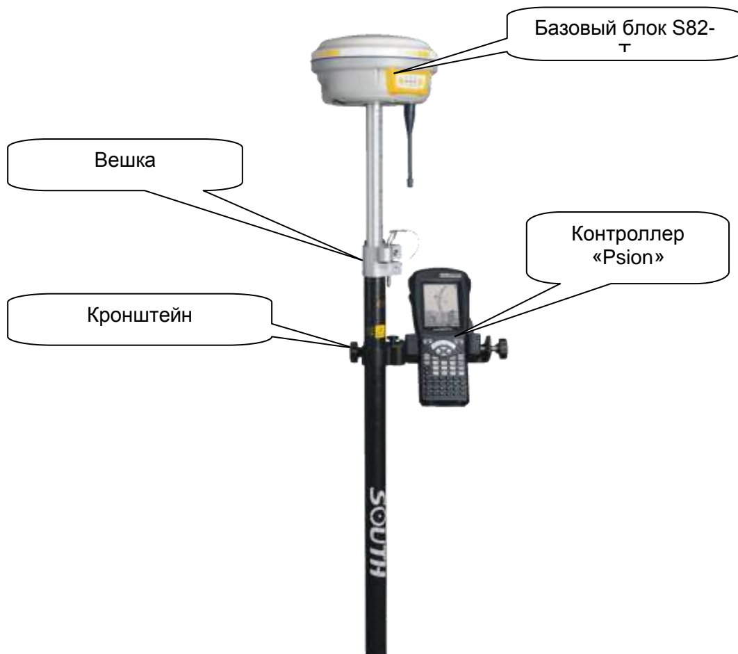
Рисунок 4.2 – Установка роверного комплекта S82-Т
