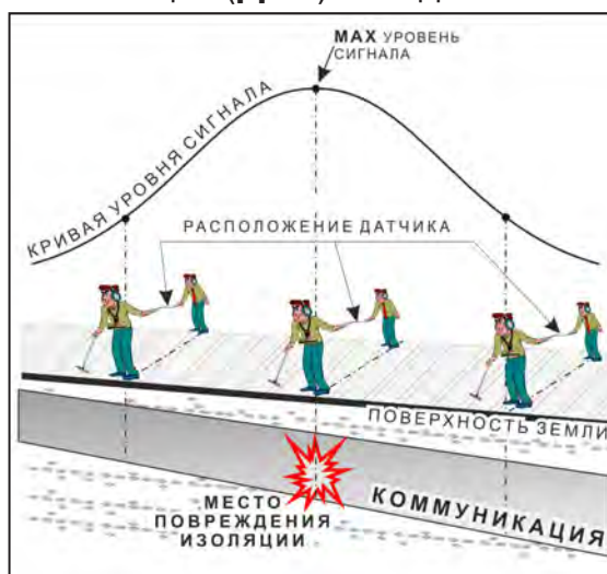
применение датчика-определителя дефектов коммуникации (ДОДК) методом тах
