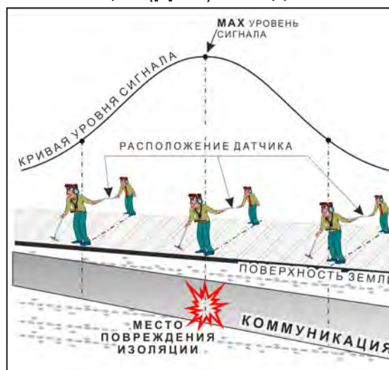
применение датчика-определителя дефектов коммуникации (ДОДК) методом max
