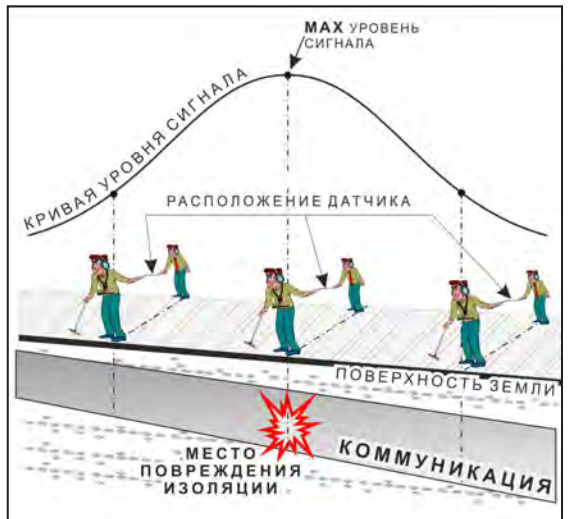
применение датчика-определителя дефектов коммуникации (ДОДК) методом max
