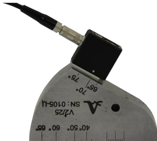
Угол калибруемого ПЭП больше 62^\circ
