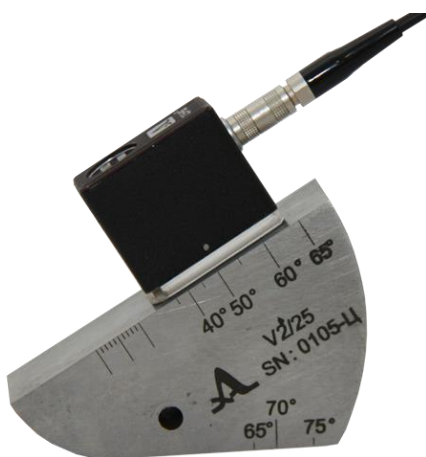
Угол калибруемого ПЭП меньше или равен 62^\circ
