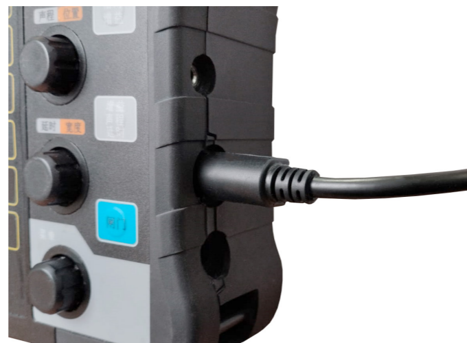
Рис. 56 Подключение основного кабеля к прибору
