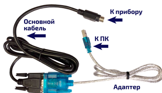
Рис. 59 Соединение основного кабеля и адаптера
