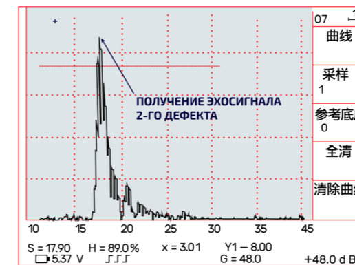
Рис. 32 Эхосигнал 2-го дефекта
