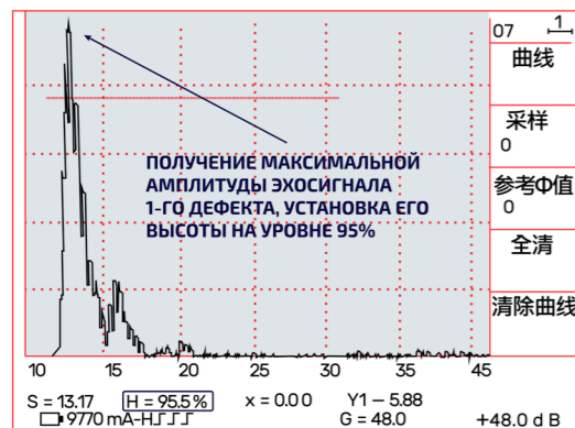
Рис. 30 Эхосигнал первого дефекта
