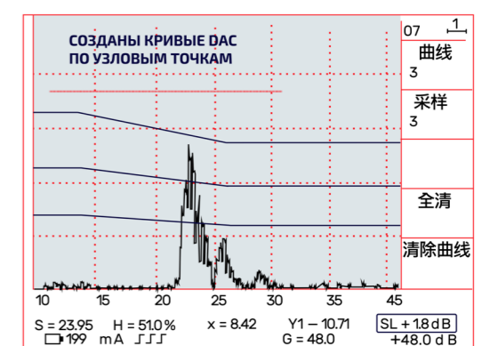
Рис. 37 Созданы кривые DAC по узловым точкам
