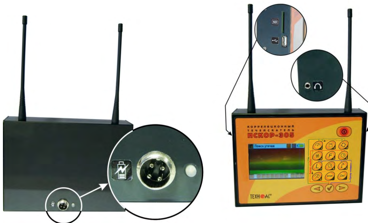
Рисунок 5 Корреляционный приемник «КП-305» с органами подключения
