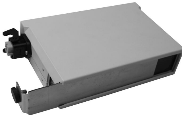
Рис. 7. Аккумуляторный отсек с выдвижной крышкой и фиксирующим невыпадающим винтом
