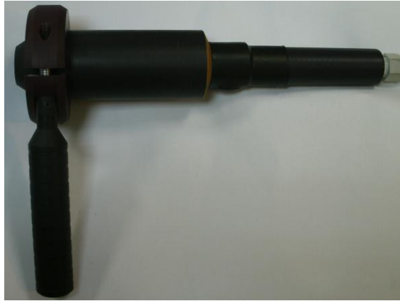
Рис. 20а. Высоковольтный трансформатор-держатель с надетой съемной ручкой.
