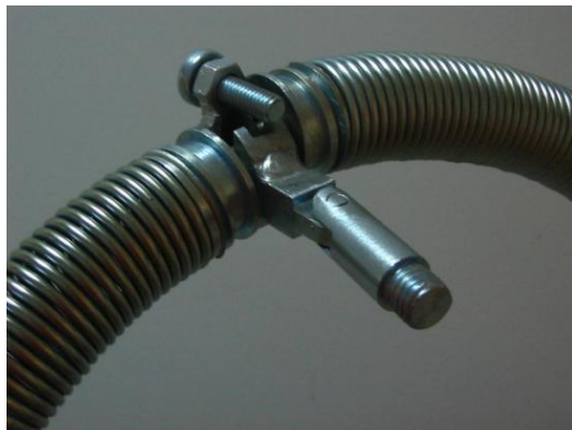
Рис. 19. Подготовленный к проведению контроля пружинный электрод
