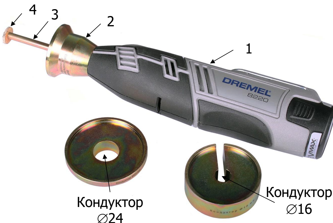
Рисунок 3 – Внешний вид расточного устройства с электроприводом и кондукторов
