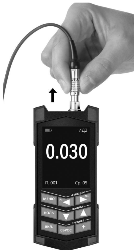
Рис. 2. Отсоединение преобразователя от электронного блока
