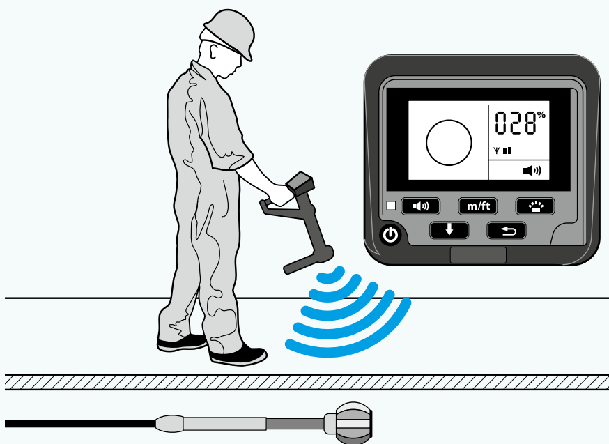
Поиск местоположения головки камеры системы телеинспекции jProbe LPM, находящейся вне зоны видимости, с помощью локатора
